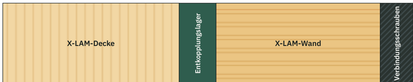
Abbildung 4. Schematischer Anschlussschnitt, ersetzt nicht die Zeichnungen S11A.
